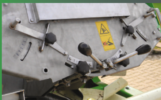
Agregato nustatymas sekcijoms valdyti ir automatiniam paskleidimo pločiui sumažinti (parinktis)
